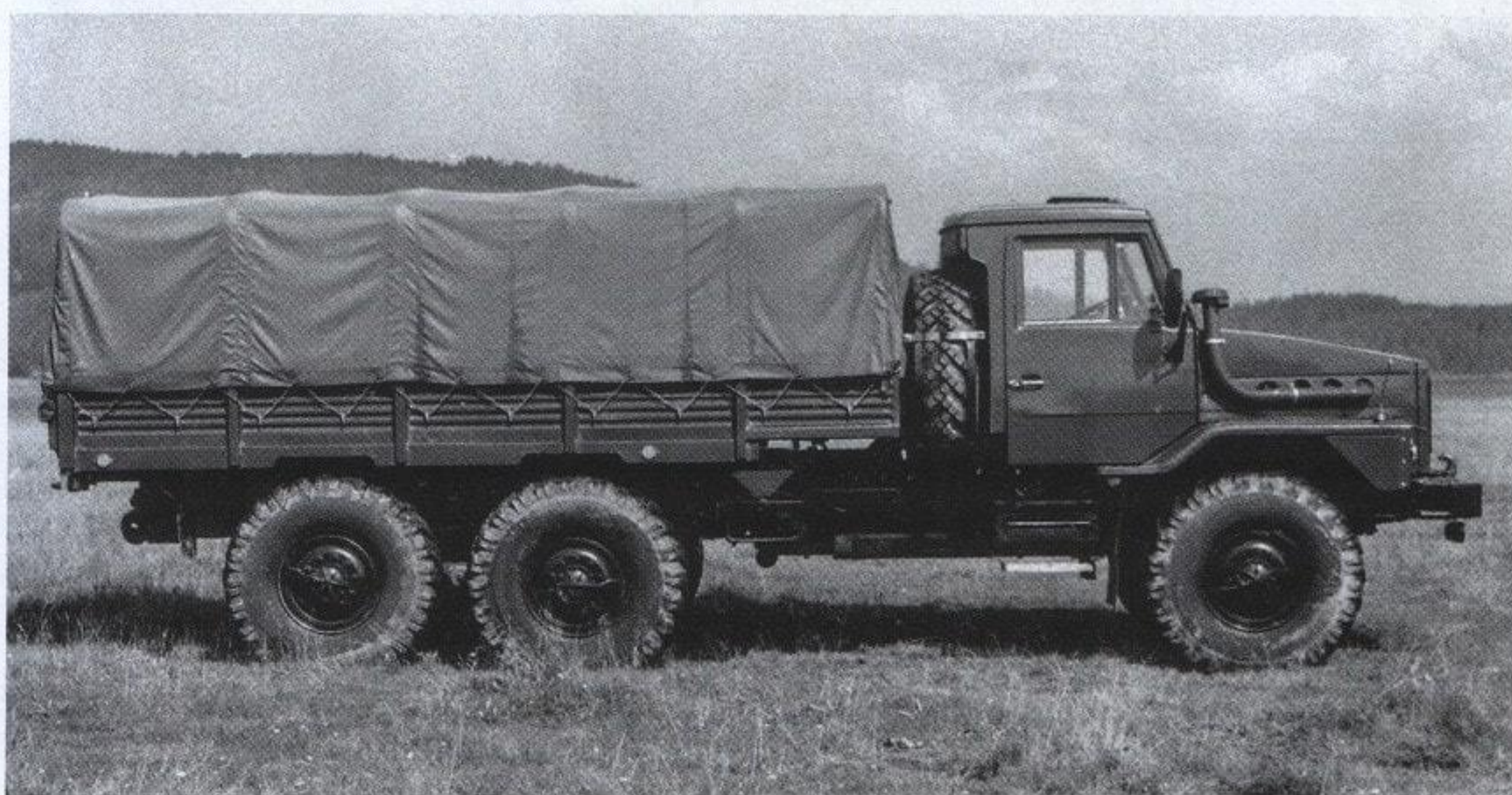
«Урал-43223». Хорошо видно размещение запасного колеса — частично в нише кабины
