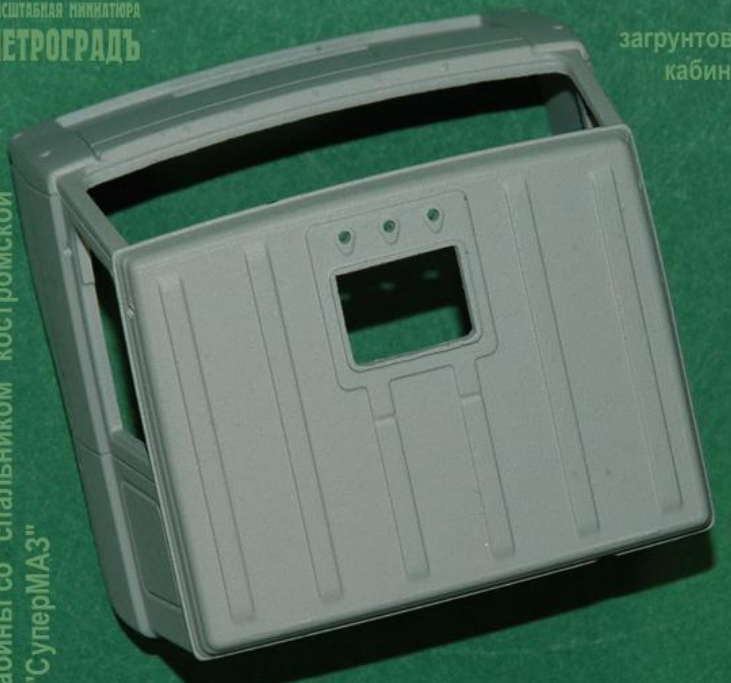
кабина окрашена краской Tamiya TS-27 из баллончика (3 изображения в нижнем ряду)
