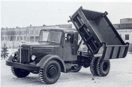
Самосвал МАЗ-506 с боковой разгрузкой кузова
