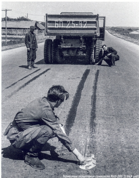
Тормозные испытания самосвала MA3-205 (1949 год)
