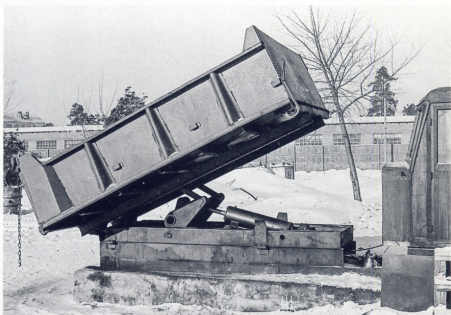
Испытания самосвального механизма MA3-205 (1950 год)
